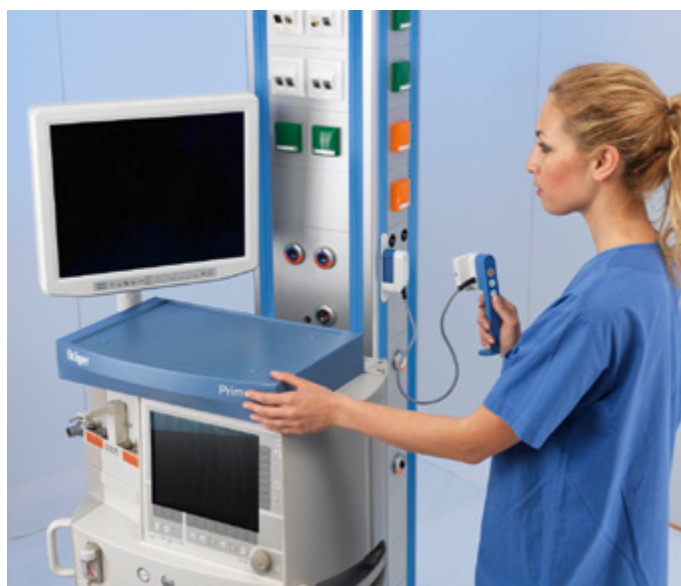
Mayor facilidad de trabajo gracias a que el mando a distancia está puesto en el riel MPC – para elevar la máquina de anestesia y manejar los frenos
