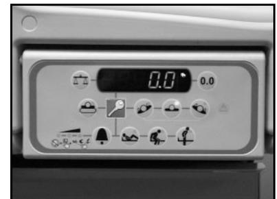
El control del Sistema de alarma de salida de cama está situado en el receptáculo de controles desplegable en el exterior de las barandas de cabecera.
