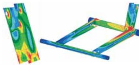
La simulación informática de la tensión de los brazos de elevación ha ayudado a determinar el diseño, el material y la resistencia de estos componentes fundamentales.
